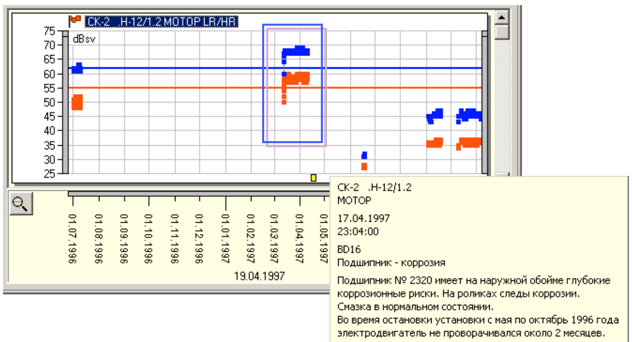
Рис. 22. Дефект подшипника электродвигателя насоса (коррозионные риски на наружной обойме после длительного простоя). Замена подшипника.
